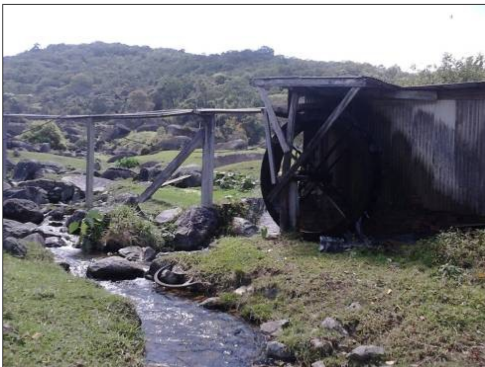
Figura 39 Rio 1 da Praia Vermelha. Roda d'água para gerar energia. Fonte: Autor.
