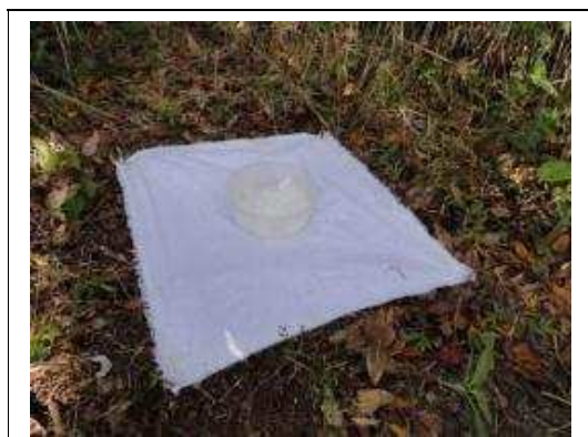
Figura 5.2: Exemplo de armadilha de atração por gás carbônico para captura de carrapatos.
