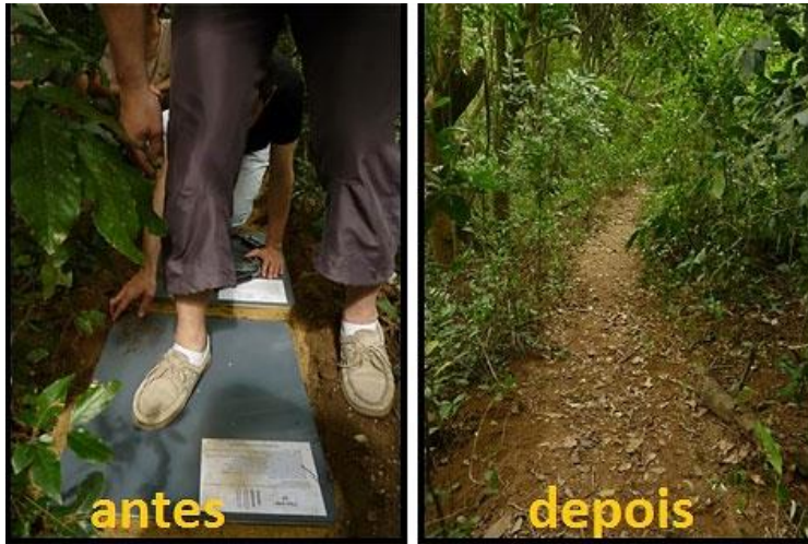
Figura 14: Instalação de Ecocontador no leito da trilha do Parque Estadual da Serra da Tiririca
