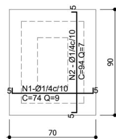
DETALHE LAJE DO FUNDO CONCRETO ESTRUTURAL
