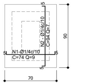
DETALHE LAJE DO FUNDO CONCRETO ESTRUTURAL
