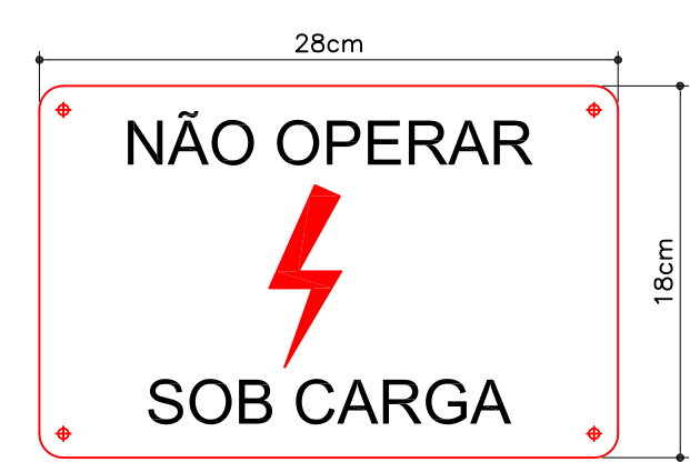
DETALHE PLACA ADVERTÊNCIA SEM ESCALA
