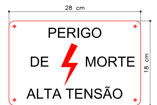
DETALHE PLACA ADVERTÊNCIA SEM ESCALA
