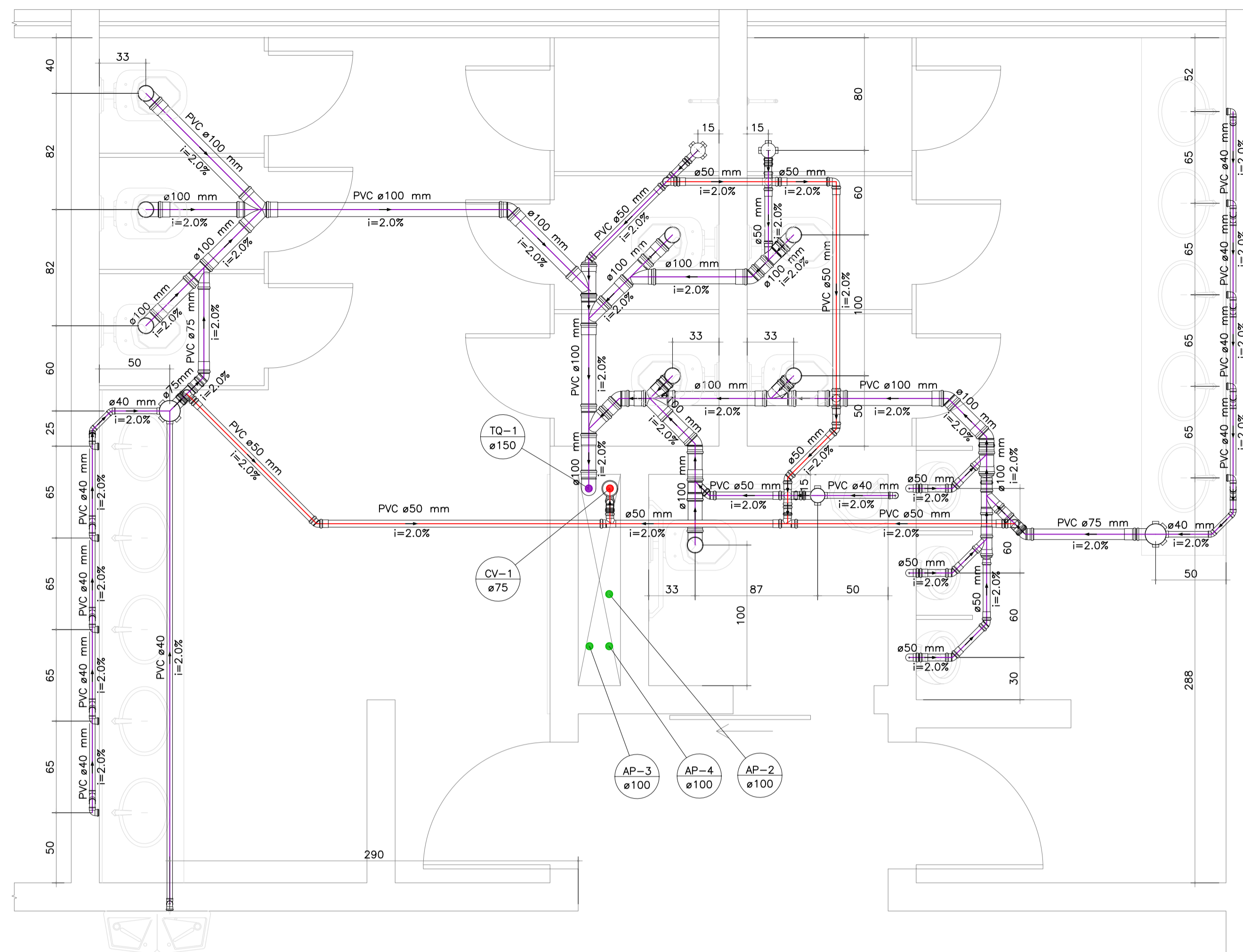
DETALHE SANITÁRIO BANHEIROS DE USO COMUM ESCALA 1/25
