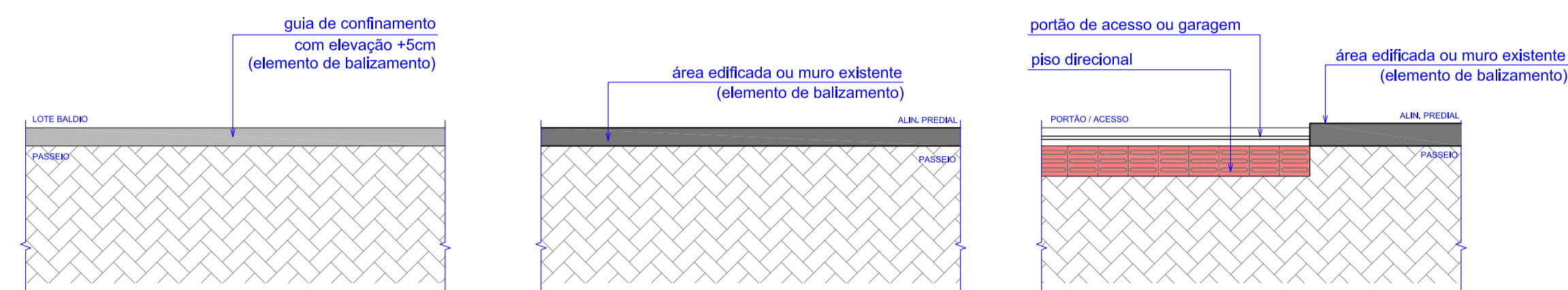
Balizamento em alinhamento predial Escala 1:50
