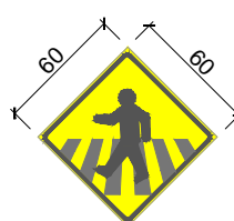
A-32b Passagem sinalizada de pedestres
