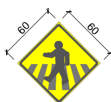
A-32b Passagem sinalizada de pedestres
