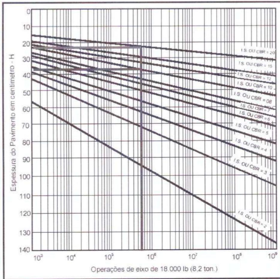
Figura 1 - Ábaco de dimensionamento (fonte: DNIT)
