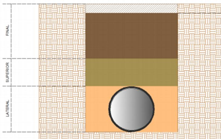
Figura 1 - Camadas de reaterro conforme NBR 7367
