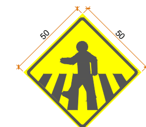
A-32b - PASSAGEM SINALIZADA DE PEDESTRES
