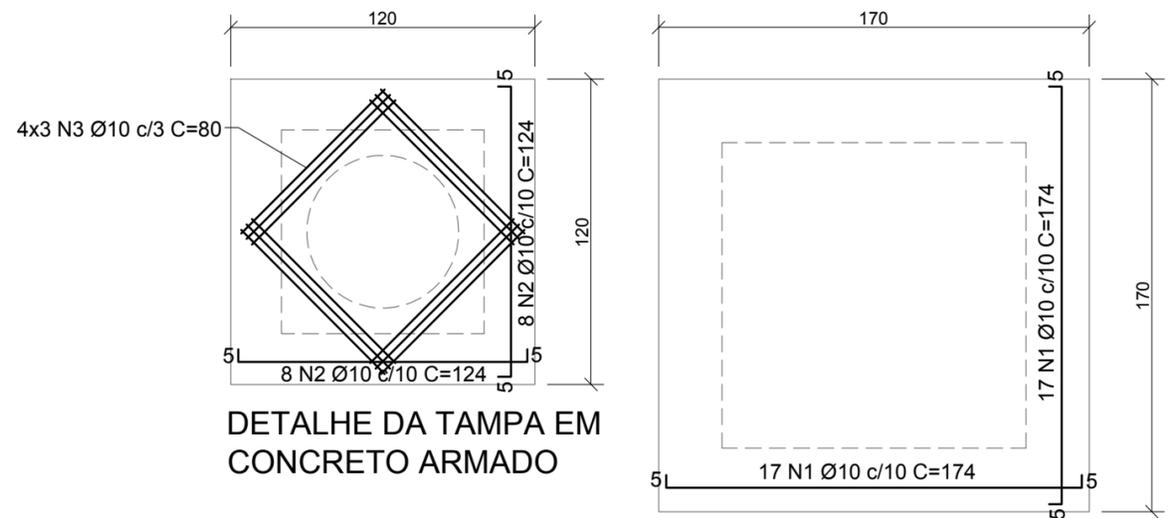
DETALHE DA TAMPA EM CONCRETO ARMADO
