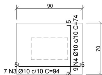
DETALHE DA LAJE INTERMEDIÁRIA EM CONCRETO ARMADO
