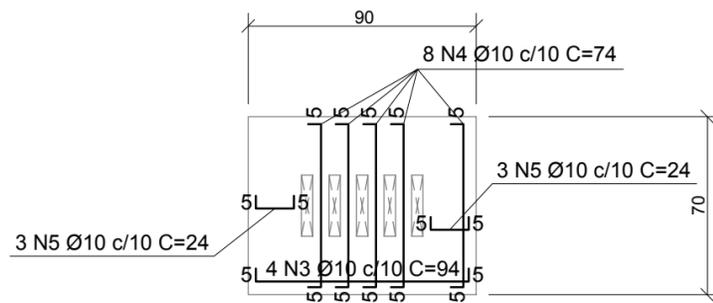
DETALHE DA GRELHA EM CONCRETO ARMADO
