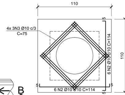
DETALHE TAMPA EM CONCRETO ARMADO
