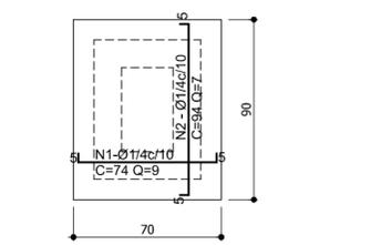
DETALHE LAJE DO FUNDO CONCRETO ESTRUTURAL
