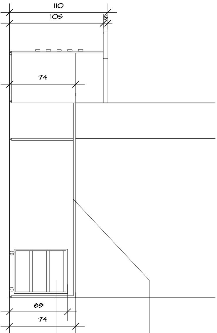
Tampo da mesa em MDF branca, com 25 mm de espessura, laterais e sustentação também 25 mm e sapatas niveladoras.
