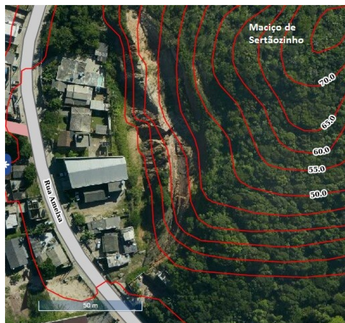
Área de risco de deslizamento (D1), Sertãozinho (SIG Geo Bombinhas).
