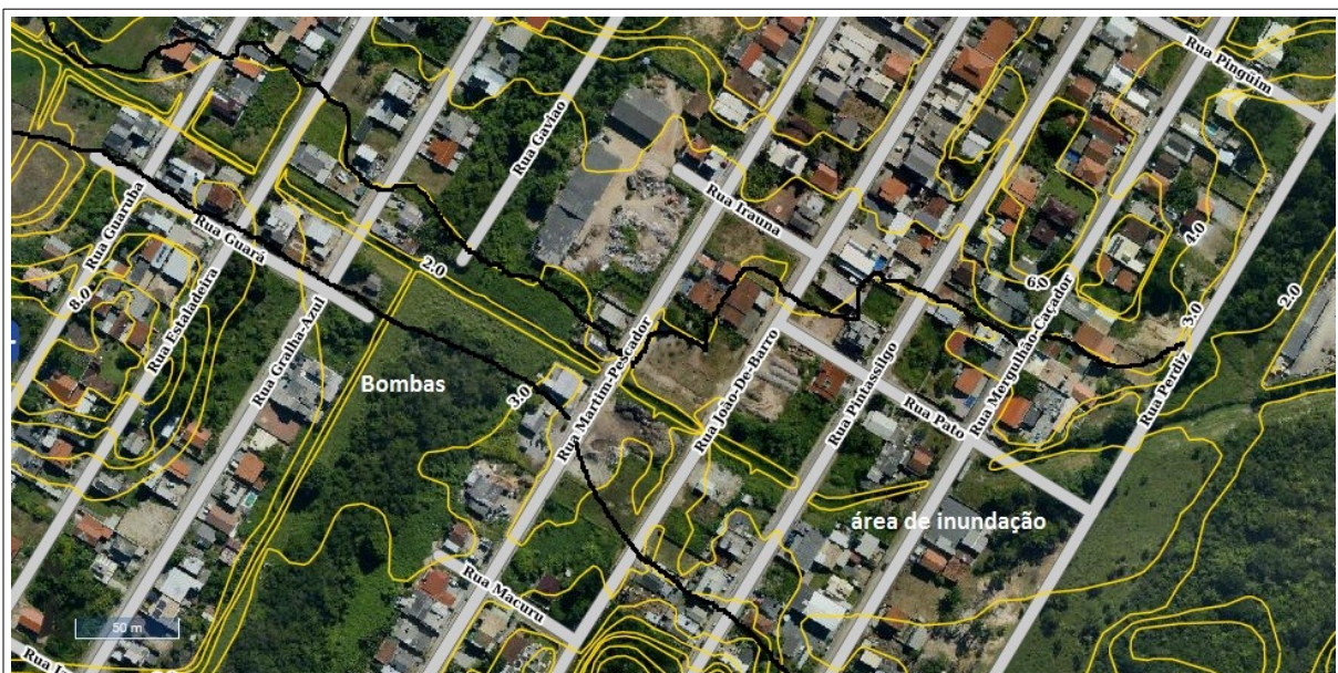
Área de risco de inundação (A4) no fundo de Bombas (SIG Geo Bombinhas).
