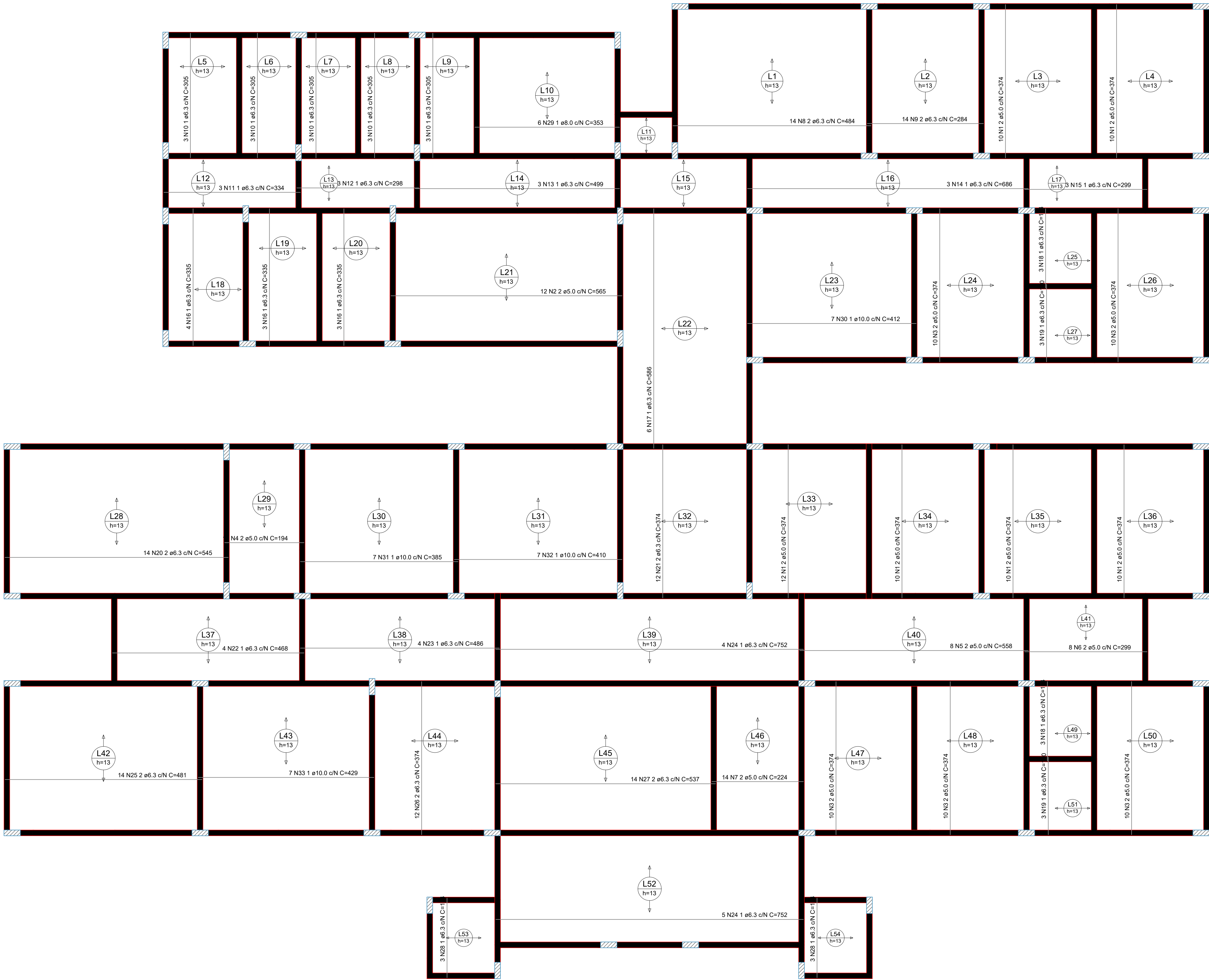
Armação positiva das lajes do PAVIMENTO TERREO
